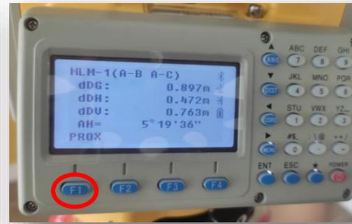
La estación mostrará los valores de distancia inclinada, distancia horizontal, distancia vertical y ángulo horizontal. Si deseamos medir otro punto (es decir al C para determinar sus distancias al punto A) presionamos F1 PROX. Nótese que la distancia vertical es positiva lo cual hace referencia que el punto B está más alto que el punto A.
