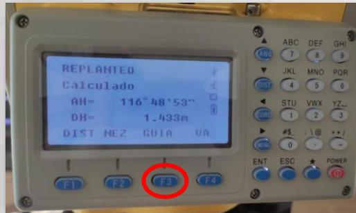
Seleccionamos la opción GUIA mediante la tecla F3 para conocer la dirección y el ángulo que debemos rotar la estación para llegar a la visual del punto a replantear.
