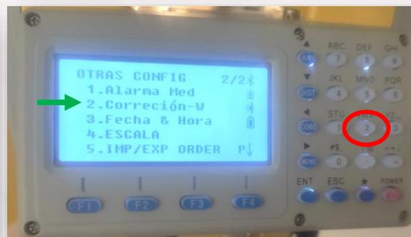
La opción 2 de la página 2 nos permite configurar la constante de refracción vertical debido a parámetros atmosféricos y curvatura terrestre (conocida como W).
