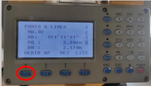
Visar y medir el punto final de la línea mediante la tecla F1. También puede ser seleccionado desde una lista mediante F4.
