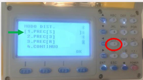
Se puede configurar el modo PREC(S) que hace referencia a una sola medición (single), PREC(3) determina el promedio de 3 mediciones, PREC(R) para mediciones repetidas constantes y CONTINUO para el modo tracking. Seleccionar alguna de las opciones y luego OK (F4).
