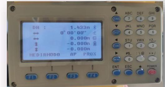
Al realizar la medición, la estación muestra en la tercera fila el desplazamiento horizontal hacia el punto, en la cuarta fila el desplazamiento longitudinal (hacia adelante o hacia atrás) mientras que la quinta fila representa la diferencia en altura.
