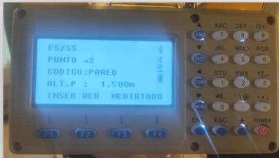
Nótese que al terminar de medir el punto 1, la estación automáticamente cambia el nombre a 2. En este momento se puede apuntar al siguiente punto y realizar su levantamiento. Es importante siempre verificar la altura del prisma y el tipo de reflector (Sin Prisma, Prisma y diana).
