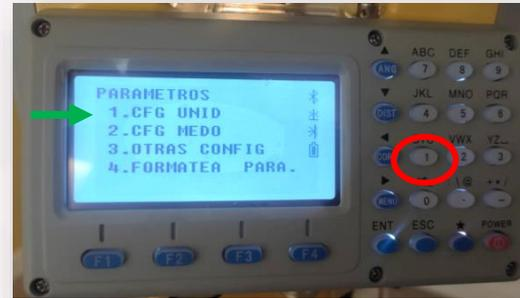
Debemos configurar las unidades de medición de distancia, ángulos, temperaturas, entre otros. Presionar 1 – para ir a CFG UNID
