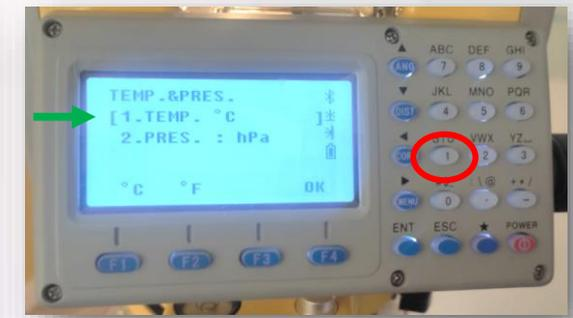
Se debe configurar la temperatura en ° C primero presionando la tecla N° 1 y luego la tecla F1. Para pasar a la presión atmosférica se debe pulsar la tecla N° 2.
