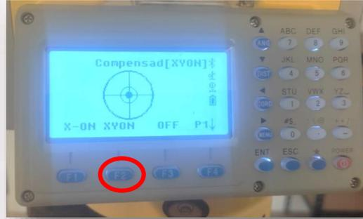
En la página 1 podemos ver gráficamente la estabilización del equipo. En la parte superior las opciones para prender y apagar el compensador. Para realizar mediciones el compensador debe estar en la opción XYON, es decir pulsar la tecla F2.
