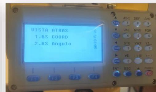
La primera opción mediante una coordenada conocida del punto referencia y la segunda opción mediante ángulo o azimut hacia la referencia.
