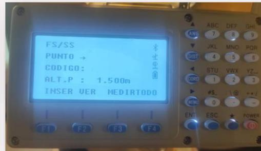
Para realizar el levantamiento de un punto es necesario configurar su nombre, código y la altura del prisma. La opción MEDIR solo efectúa la medición y la muestra en pantalla. Mientras que la opción TODO mide y guarda automáticamente.
