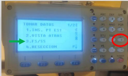
Una vez configurados correctamente el estacionamiento y orientación del instrumento, se procede a seleccionar la 3era opción FS/SS en el menú de toma de datos.
