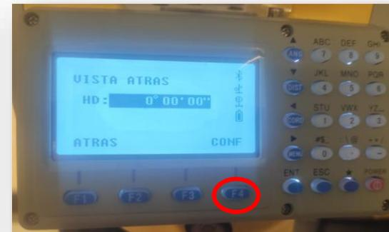
Se define el azimut entre la estación y la referencia. En el caso de trabajar con un sistema arbitrario se puede dejar en 0° 0' 0". Posteriormente pulsar F4 para confirmar.
