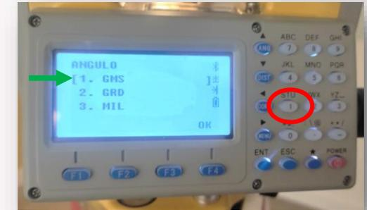
Para unidades angulares tenemos las opciones GMS (Grados Minutos Segundos), GRD (Grados) y MIL (Mil angular). Debemos seleccionar 1. GMS y presionar OK (F4).
