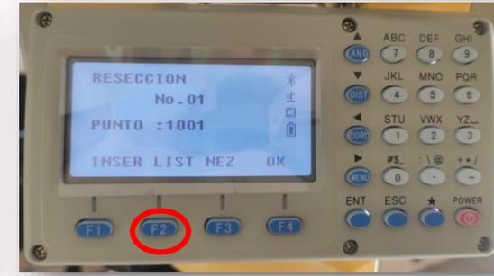
La estación nos pide ingresar la información del punto N° 1 de la resección a lo cual debemos buscarlo en lista mediante F2 o ingresar las coordenadas mediante NEZ.
