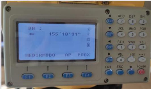
La estación nos mostrará el sentido con una flecha y el valor del ángulo que debemos rotar la estación horizontalmente hasta llegar a 0°.
