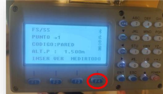
Una vez configurados todos los elementos se procede a pulsar F4 para medir y guardar la información del punto medido.
