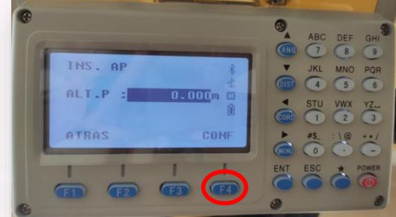
Configurar la altura del prisma. En el presente ejemplo se deja en 0 porque se está trabajando sin prisma. Pero debe revisarse y configurarse esta altura dependiendo del tipo de medición.
