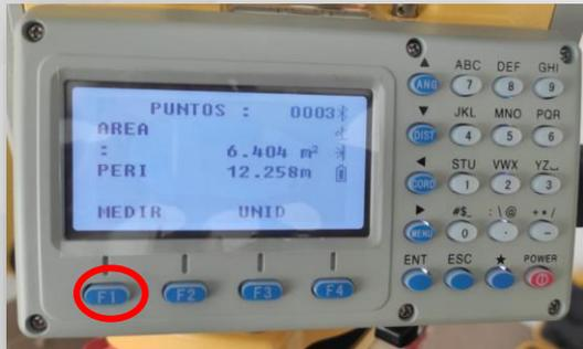
Apuntar hacia el tercer punto y medir con F1. En este momento al tener un triángulo como mínimo, la estación muestra los valores de área y perímetro.
