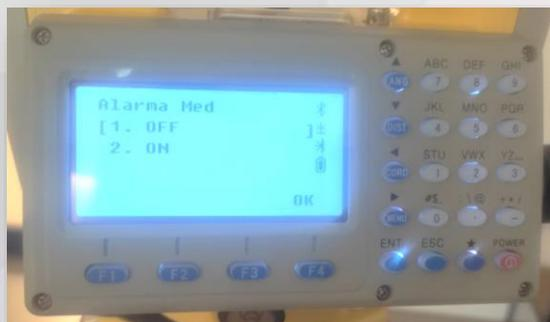
La opción a configurar depende de la decisión del operador. OFF representa la opción para ahorrar energía en este sentido. ON para obtener el sonido y saber que se realizó la medición con éxito. Presionar 1 o 2 y posteriormente pulsar OK (F4).
