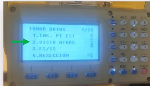
Una vez configurado el punto estación, es posible pasar al proceso de orientación del equipo o establecimiento de la vista atrás. Existen distintos métodos para realizarlo.
