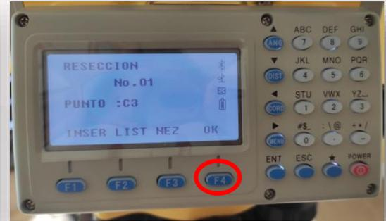
Una vez ubicado el vértice se confirma en F4 Ok para visualizar sus coordenadas.
