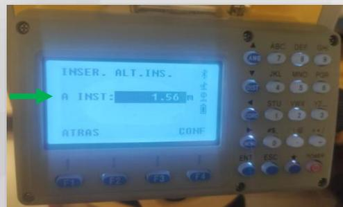
Ingresar la altura instrumental tomando en cuenta que el flexómetro o cinta métrica esté lo más vertical posible entre el punto estación materializado y la referencia central del instrumento.
