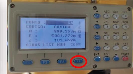
Una vez ubicado el punto a replantear se confirma mediante la tecla F4.
