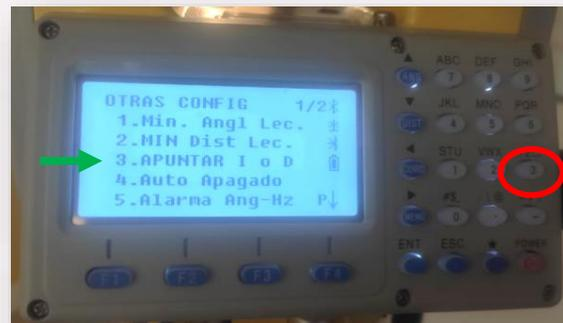
La opción 3 nos permite configurar el sentido en la medición de los ángulos horizontales. Presionar la tecla N° 3.
