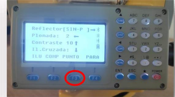
Para encender el puntero láser se debe presionar la tecla F3. Recuerde apagar el puntero láser al no requerirlo, dejarlo encendido tiempo prolongado consume mayor batería.
