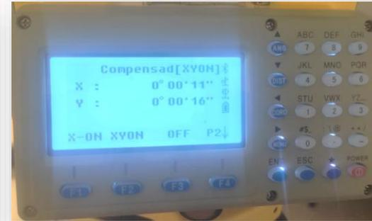
En la página 2 podemos ver numéricamente la desviación de la estabilización o nivelación del instrumento para ambos ejes. El operador debe estabilizar el equipo alcanzando el menor número posible de segundos en ambos ejes en todas las direcciones de la estación. Si no es posible llevar esos valores a números pequeños puede ser consecuencia de falta de calibración y ajuste del equipo.
