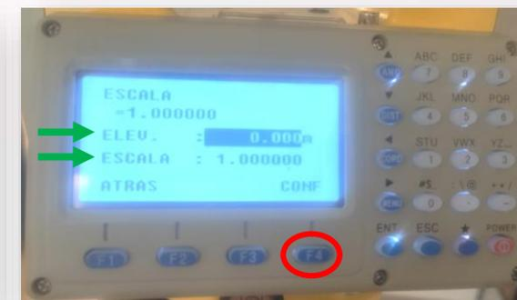
En ELEV se debe configurar la altura del plano topográfico en el cual vamos a trabajar y en ESCALA el factor deseado. 1.00000 es para trabajar en un plano topográfico donde las distancias no se encuentran distorsionadas.
