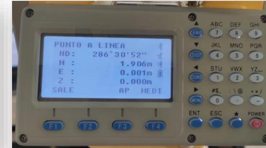
Una vez visado el punto, se pulsa F4 para medir y la estación nos mostrará las coordenadas del punto medido con respecto a la línea definida. En el caso del ejemplo, el punto medido se encuentra a 1.906 m sobre la línea, a 1 mm de diferencia hacia la derecha de la línea y a igual altura de la línea definida. Se puede repetir la medición en F4 para buscar el lugar deseado del punto con respecto a la línea.
