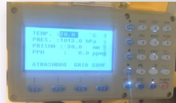
Configurar correctamente los parámetros de temperatura, presión atmosférica, constante del prisma y la estación calculará automáticamente el ppm a aplicar a la medición de distancia, mediante la fórmula:
