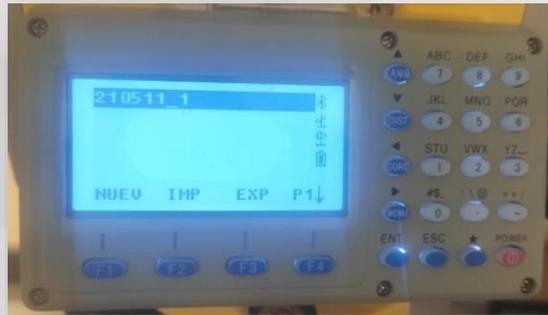
Para ingresar manualmente datos de puntos de control se selecciona el archivo de coordenadas creado mediante la tecla ENT.
