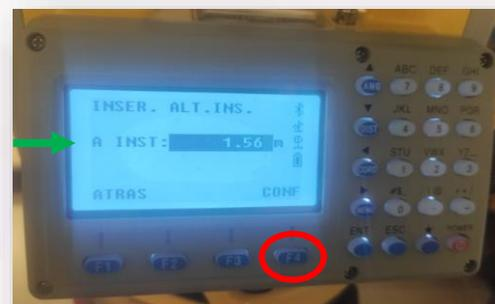
Como último paso debemos ingresar el valor de la altura instrumental utilizando para ello una cinta métrica y midiendo desde el punto estación hasta la marca central del instrumento. Finalmente se presiona F4 y la estación quedará orientada correctamente.
