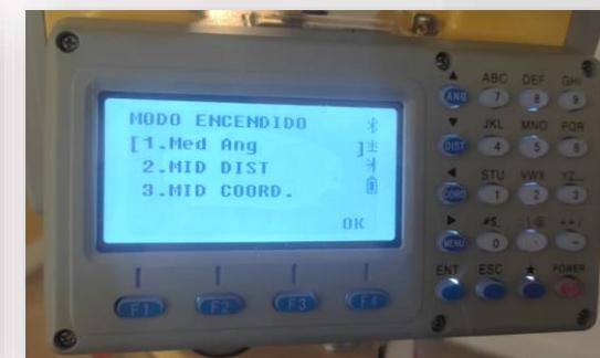
Aquí podemos configurar el modo por defecto que aparecerá en la estación al encenderla. Para medición angular presionar 1, para medición de distancia presionar 2, para medición de coordenadas presionar 3. Se debe seleccionar sólo una de las opciones y luego presionar OK (F4).
