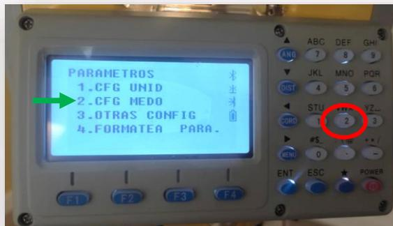
Posteriormente debemos configurar el modo de medición y las convenciones para cada una de las magnitudes a medir. Presionar la tecla N° 2 CFG MEDO
